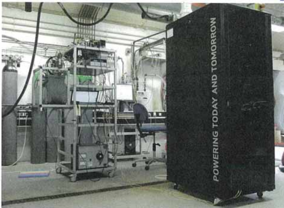
Figur 2: Brændselscelle baseret mikrokraftvarmeanlæg under test i DGC's laboratorium (fabrikat IRD-Fuel Cell Technology)
