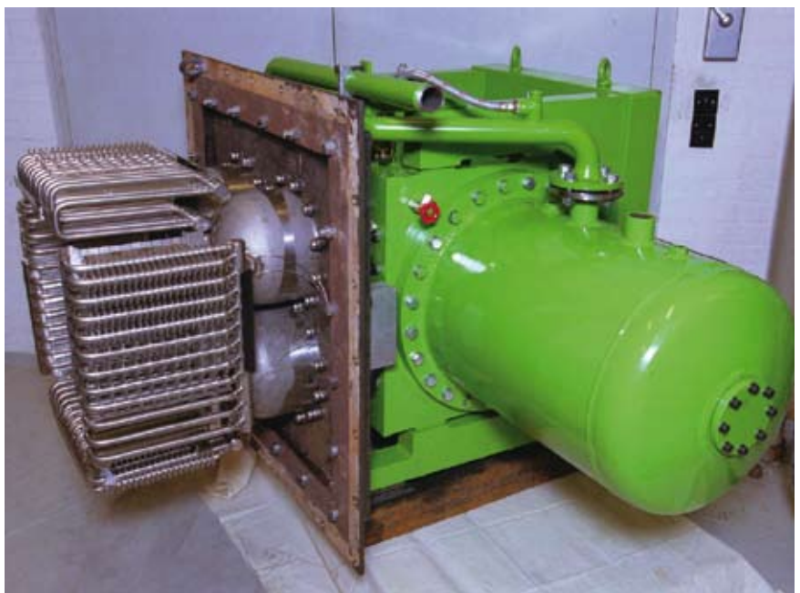
Figur 1: 35 kW SD3-Stirling-motor fra Stirling Danmark ApS. Hedefladerne ses til venstre, og brændkammeret bygges uden om disse.
