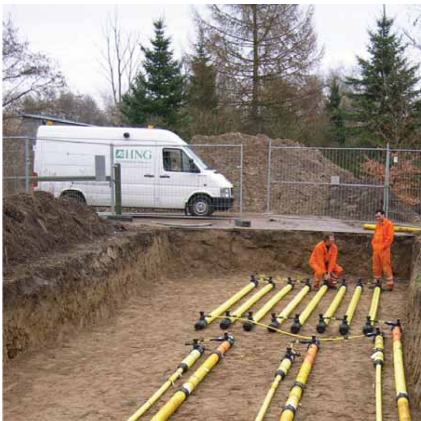
Test af plastrørnet blev gennemført hos DGC i Hørsholm over fire år.
