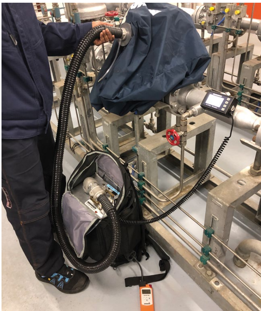
I 2017 blev et omfattende arbejde med at kortlægge metantab fra gasdistributions- og gastransmissionssystemet i Danmark sat i gang. Foto: DGC
