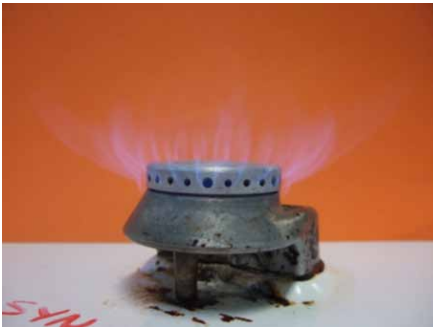
Visuel vurdering af biogas som brændsel for gasblus ved maksimal effekt.
