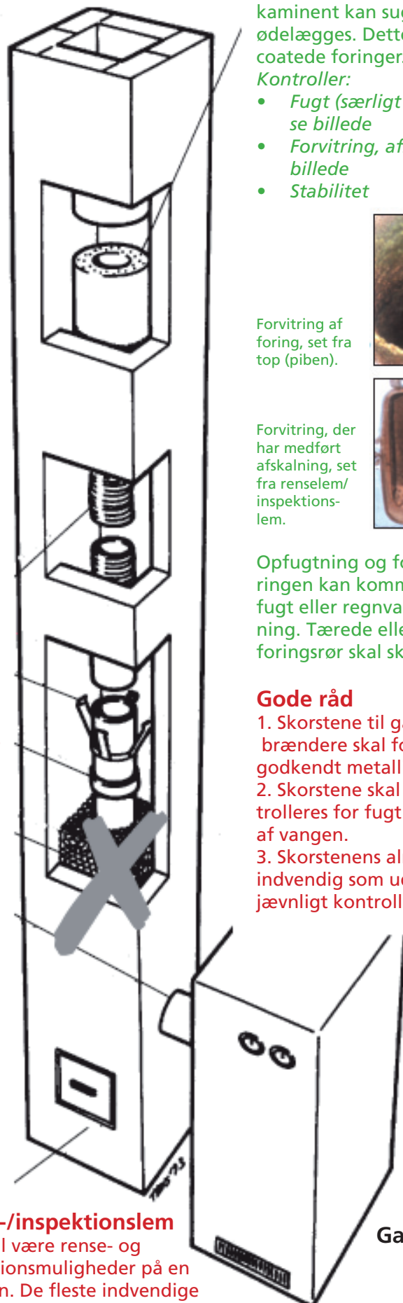
b Muret skorsten med keramisk foring (isokærn)
